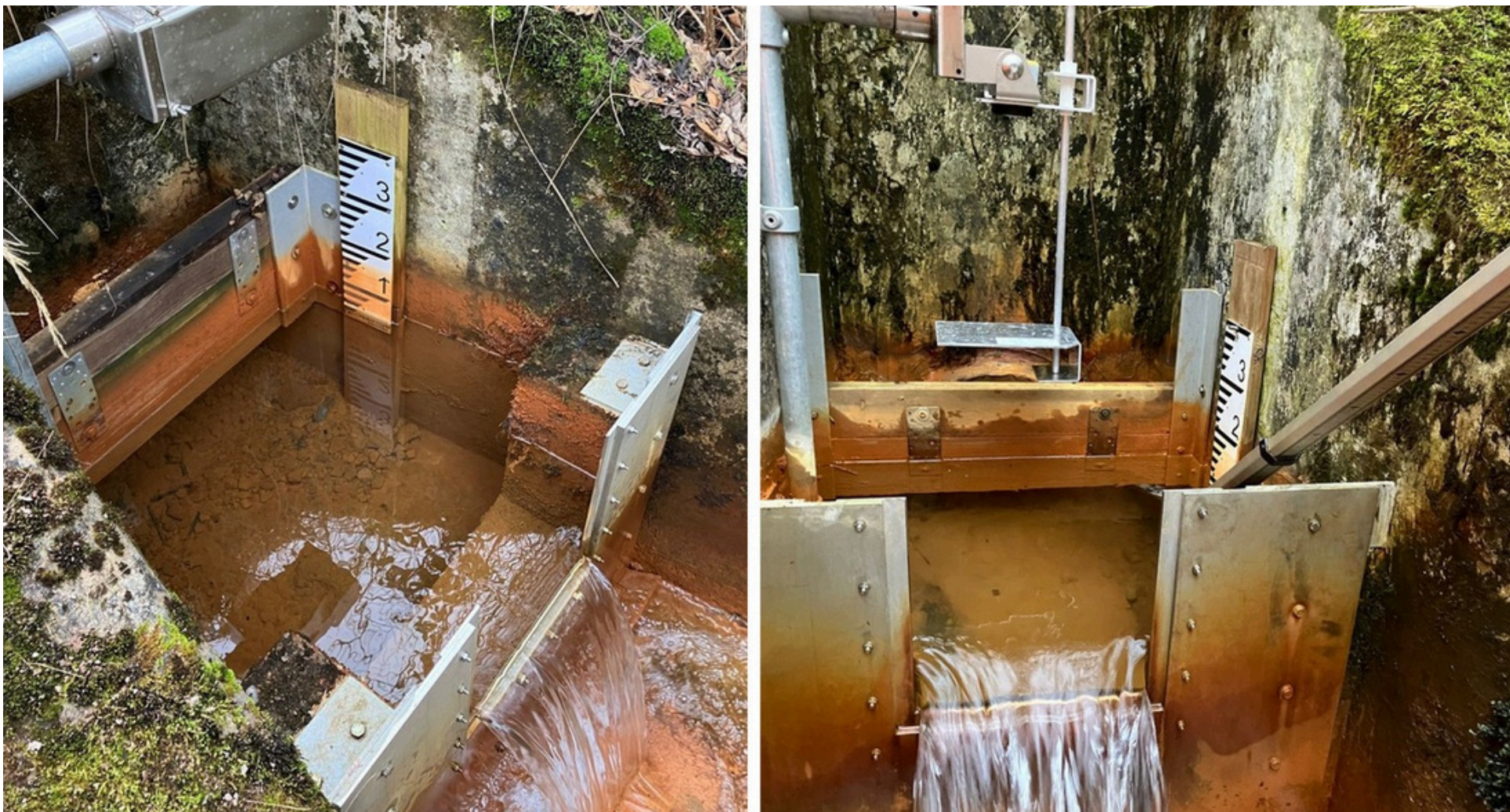
Medición de caudal en aliviadero rectangular
